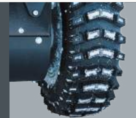
Высокая проходимость: колёса с глубоким протектором
